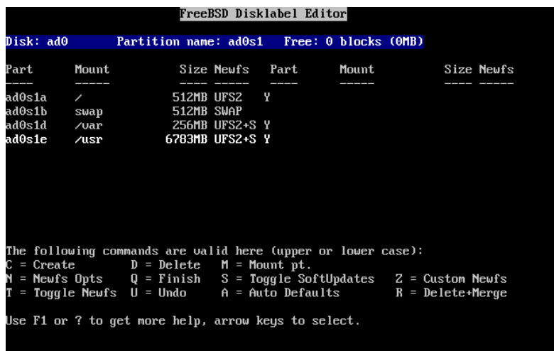
Figura 2-22. L'Editor Disklabel di Sysinstall
