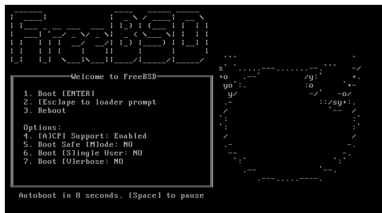
图3-1. FreeBSD 引导加载器菜单
