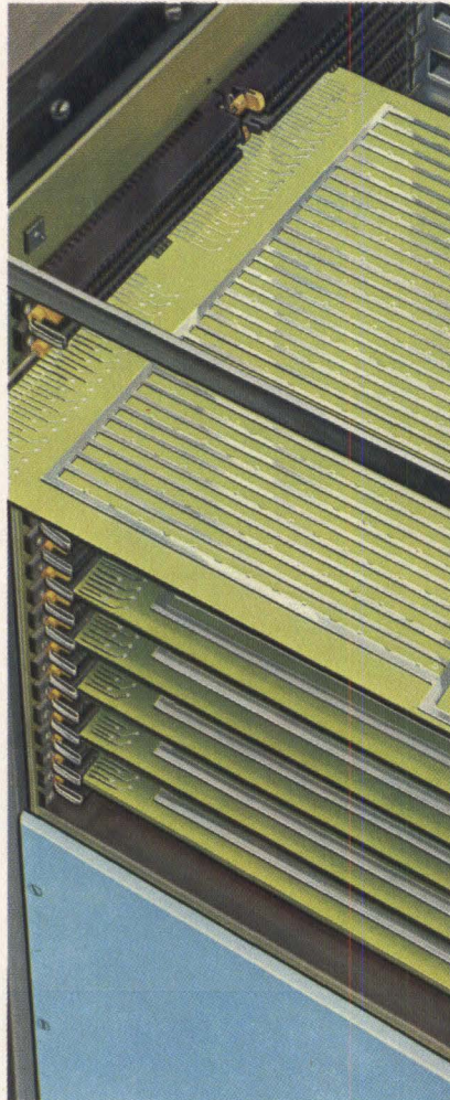
2. ZIF Connectors replace card guides
