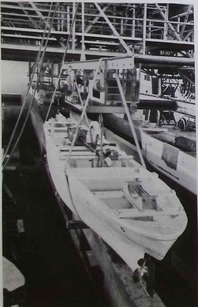
Ein Schiffsmodell wird für Schleppversuche vorbereitet
