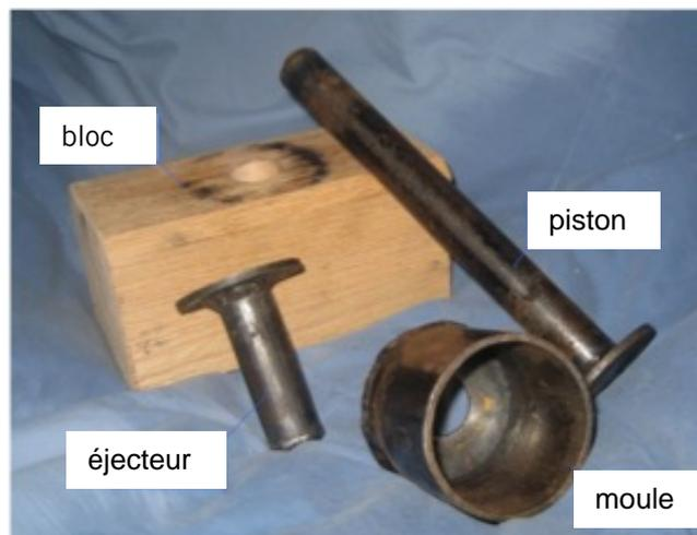
Photo n° 1 : Parties de la presse à briquettes.
