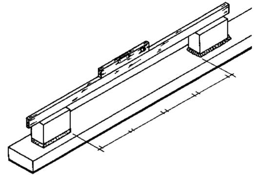
Fig. 4 LAY THE SECOND BLOCK MAINTAIN THE CORRECT DISTANCE OF 4 BUILDING UNITS PLUS 1 JOINT.
