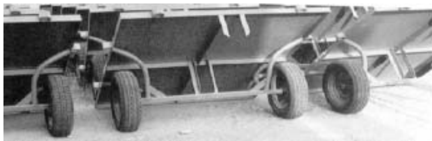
Figure 30 : Charrette à deux roues équipée d'un roulement à billes et de pneus de voiture deuxième choix. Elle est conçue pour un attelage de bœufs, mais au Togo on utilise un modèle plus petit pour un seul âne.
