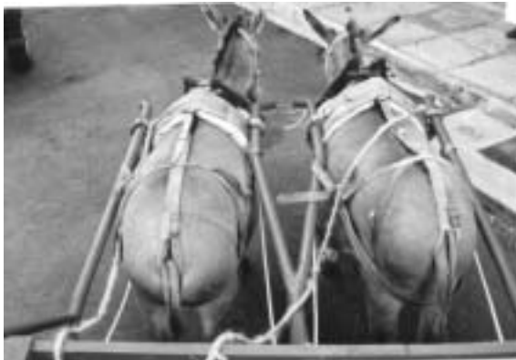
Figure 24 : Modèle à trois limons pour atteler deux ânes équipés d'un collier et d'une sellette à une charrette à deux roues (photo: Luurt Oudman).
