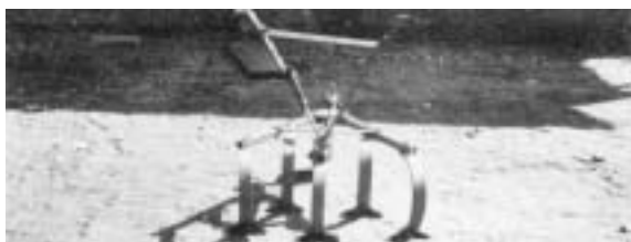
Figure 39 : La Houe Manga de cette illustration a les quatre dents de gauche alignées correctement, mais il faut ajuster la dent de droite.
