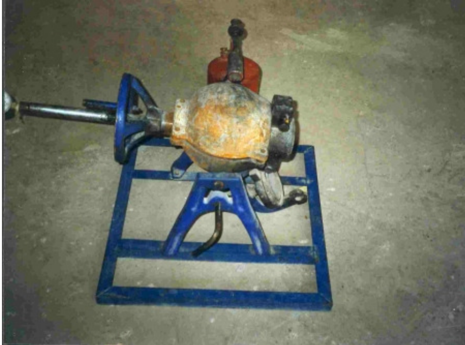
Foto 14: Tostadora de granos o "cañoncito" empleado para la obtención de productos expandidos (maná de quinua)
