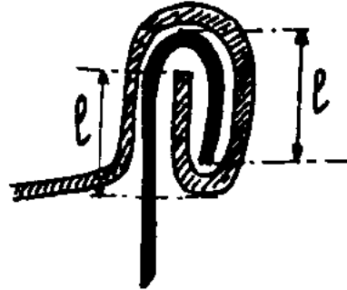
Figure 62. Jonction \diamond tanche, par sertissage, d'un couvercle m \diamond tallique sur une bo \diamond te de conserve
