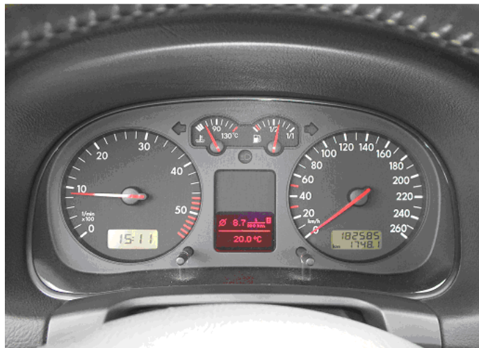
Figure 2.1: Panel de un automóvil: cuentarrevoluciones y reloj (izda), velocímetro y kilometraje (dcha), ordenador de a bordo (centro abajo), temperatura del motor y estado del depósito de combustible (centro arriba).
