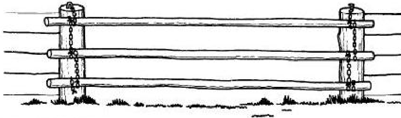
(d) A pole and chain gate
