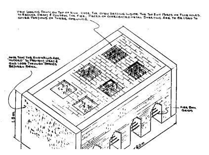
Briques dans les fins du four, près des murs de la fin du mudded, est placé plus proche à l'un l'autre pour réduire la fuite de chaleur à travers ces walls. Quand le cours du sommet de briques est construit à formez le toit du four, ses briques forment une plate-forme solide interrompue par les régions ouvertes carré de 60 centimètres (Fig. 8). Comme dans le cas de la fin
