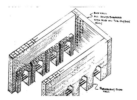
entre les briques est rempli de l'extérieur d'un mélange de argile de la brique et eau; il est enduit sur comme à la main de la même façon
