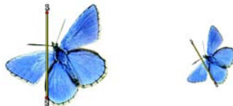
Klonen mit Drehen und Skalieren. Ursprungs- und Zielbezugspunkte sind nummeriert und durch eine Linie verbunden.
