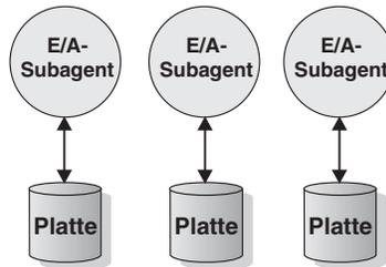
Abbildung 9. E/A-Parallelität beim Laden von Daten
