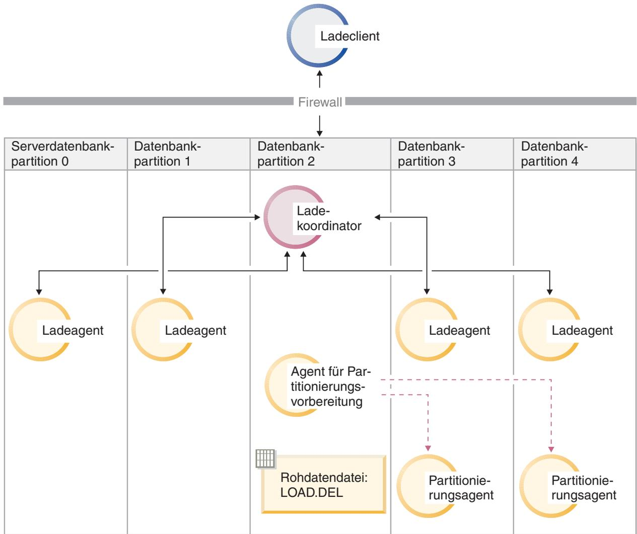
Abbildung 14. Laden von Daten in die Datenbankpartitionen 3 und 4. Diese Abbildung veranschaulicht das Verhalten, das sich bei Ausführung des vorstehenden Befehls ergibt. Die Daten werden in die Datenbankpartitionen 3 und 4 geladen.
