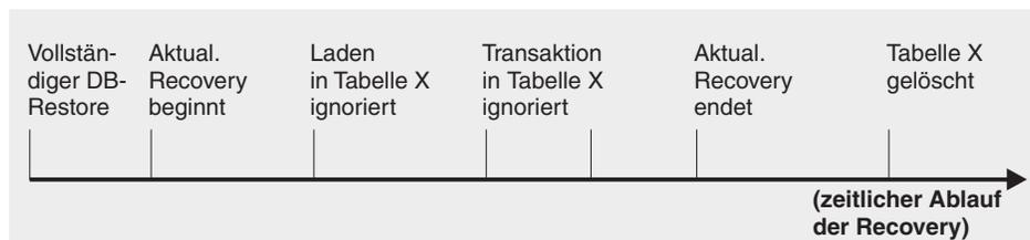
Abbildung 4. Nicht wiederherstellbare Verarbeitung bei einer aktualisierenden Recovery
