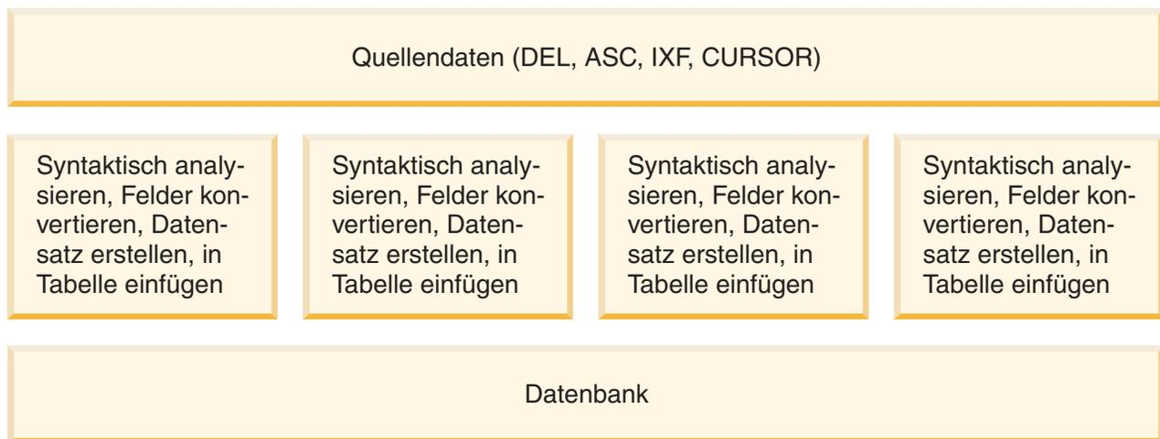
Abbildung 10. Partitionsinterne Parallelität beim Laden von Daten
