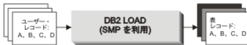
図 12. ロード操作中に、データベース・パーティション当たりの実行プロセス数を利用した場合、ソース・データのレコード順序は保持される
