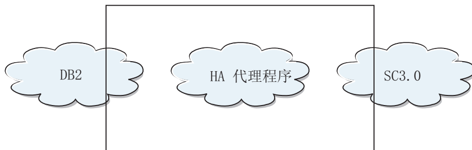
图 8. DB2 数据库、Sun Cluster 3.0 和高可用性. DB2 数据库、Sun Cluster 3.0 与高可用性代理程序之间的关系。
