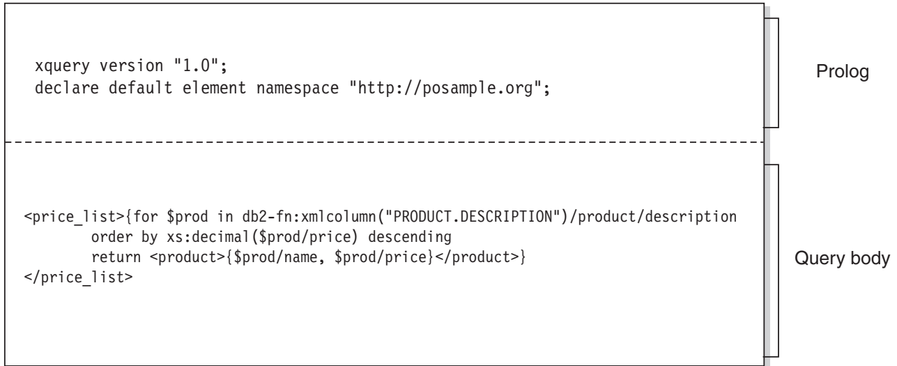
图 1. XQuery 中的典型查询的结构
