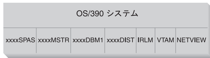
図 13. DB2 for OS/390 and z/OS によって使用される OS/390 および z/OS アドレス・スペース
