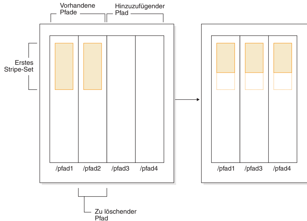
Abbildung 30. Hinzufügen und Löschen von Speicherpfaden mit anschließendem Neuverteilen der Daten in einem Tabellenbereich mit dynamischem Speicher
