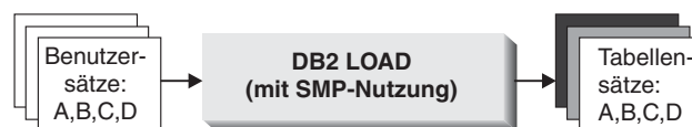
Abbildung 12. Beibehaltung der Satzreihenfolge der Quelldaten bei Ausnutzung der Anzahl von pro Datenbankpartition ausgeführten Prozessen bei einer Ladeoperation
