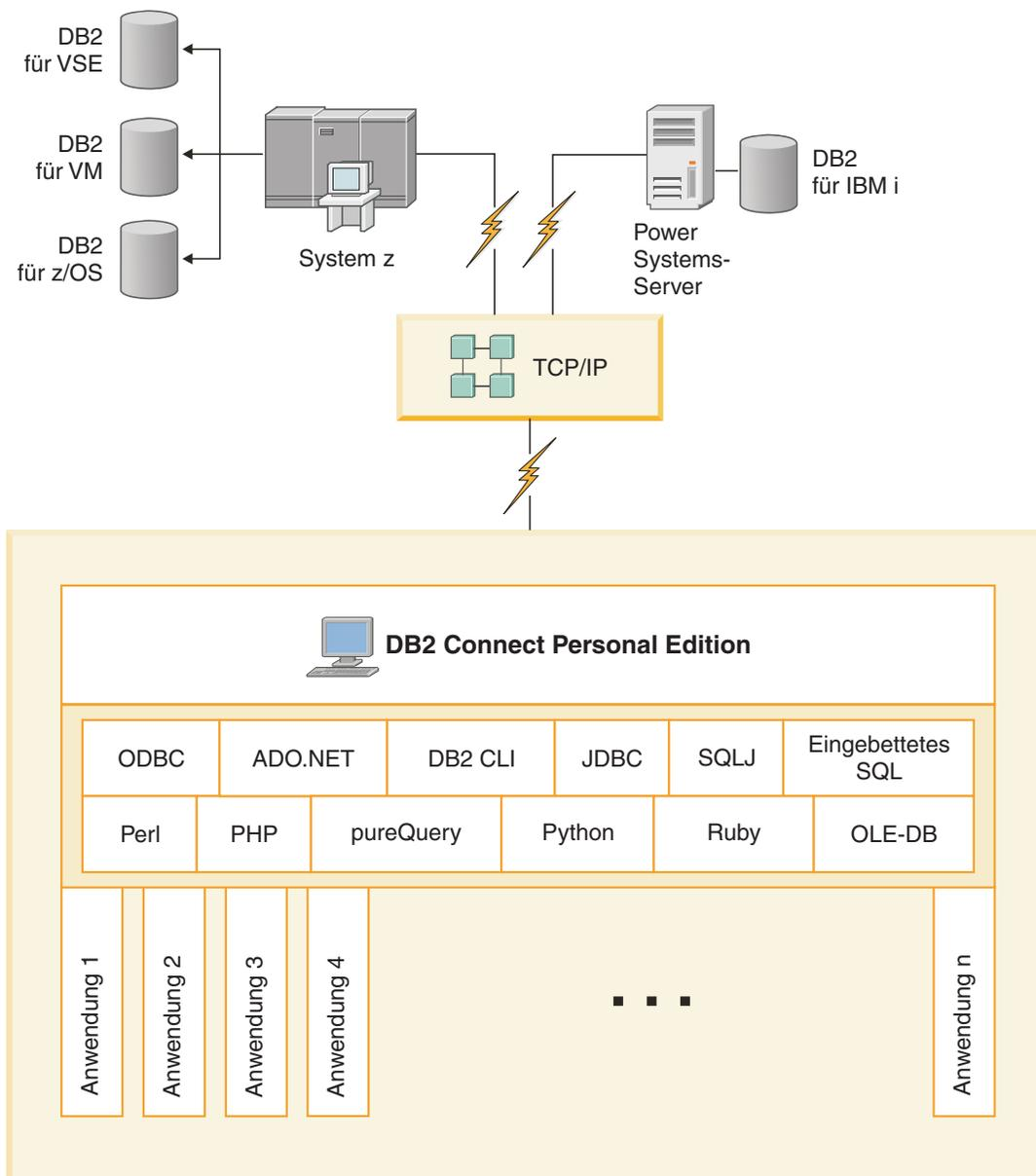
Abbildung 1. Direktverbindung zwischen DB2 Connect und einem IBM Mainframe-Datenbankserver
