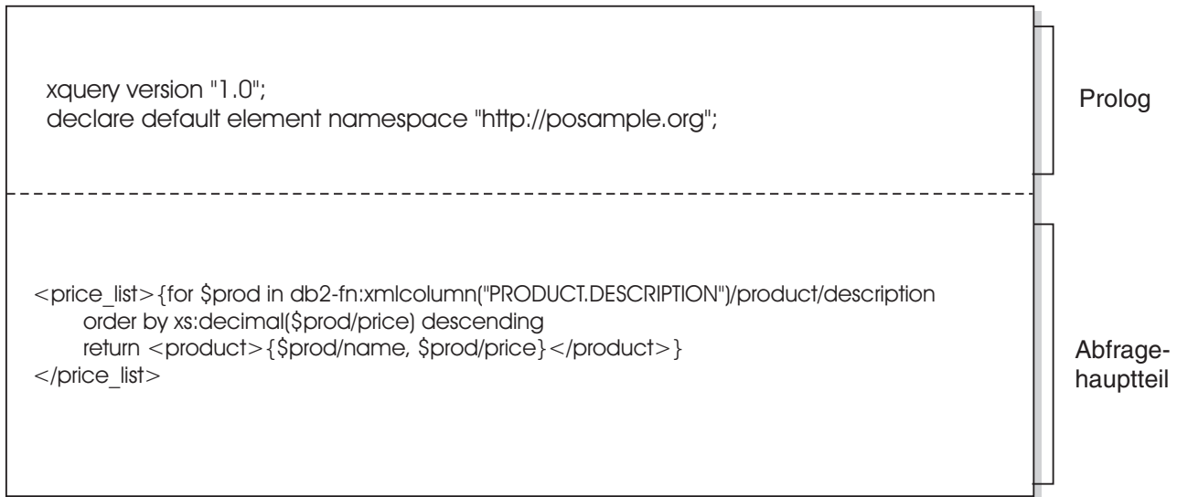
Abbildung 1. Struktur einer typischen XQuery-Abfrage
