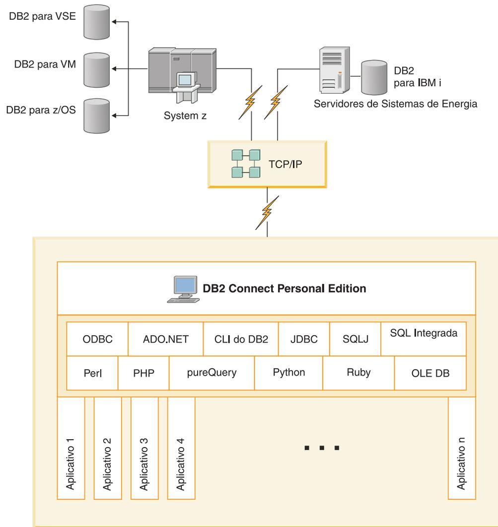
Figura 3. Conexão Direta entre o DB2 Connect e um Servidor de Banco de Dados de Mainframe IBM
