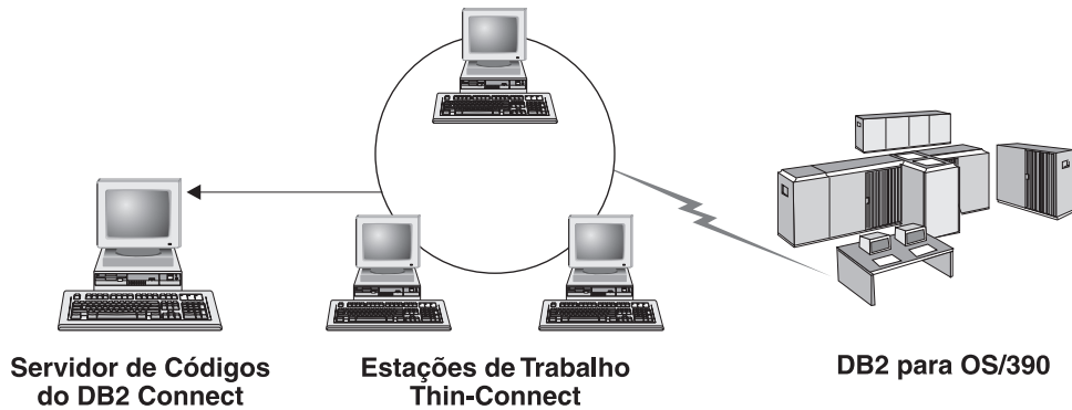
Figura 3. Uma Típica Topologia do Cliente Thin Utilizando o DB2 Connect Personal Edition
