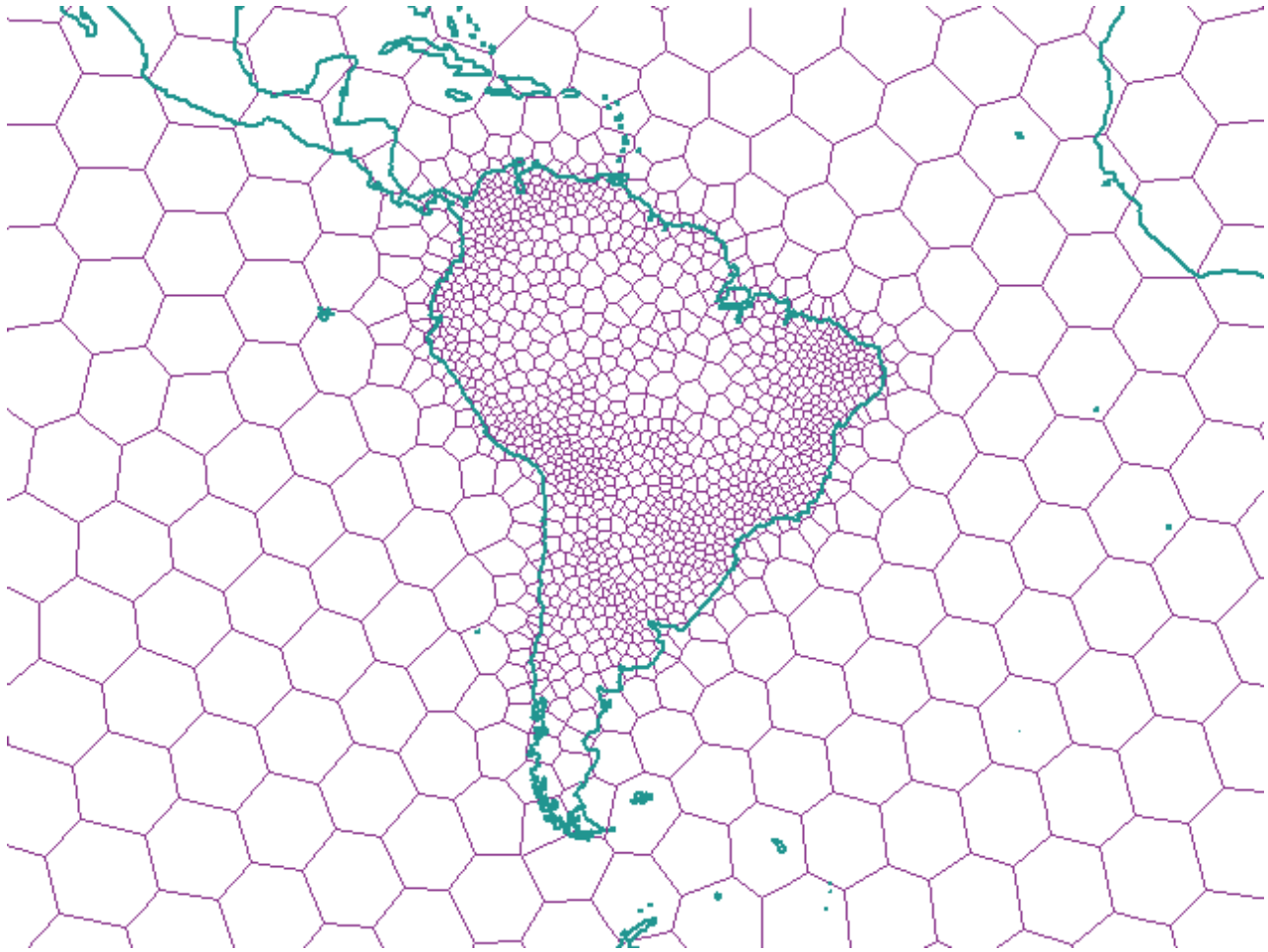
Figura 31. Estrutura de Célula de Voronoi para a América do Sul
