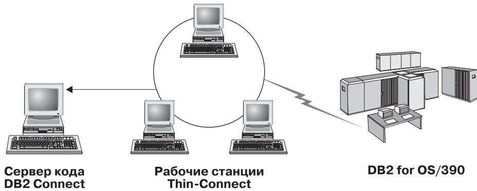
Рисунок 3. Типичная топология минимального клиента при использовании DB2 Connect Personal Edition
