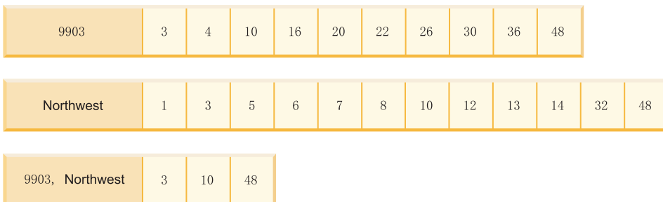
图 24. 添加第 48 个块之后维块索引中的键
