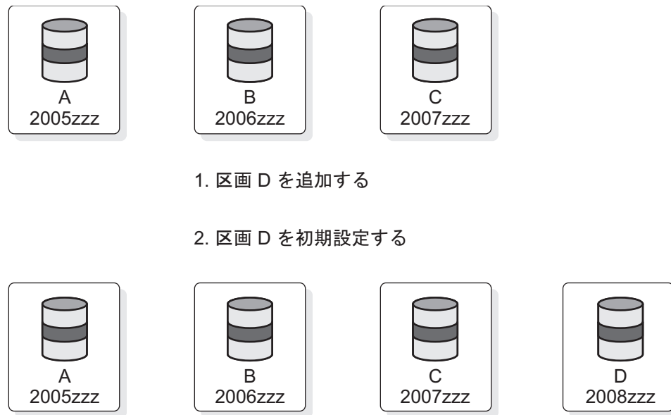
図 295. キー範囲の区分化による、より大きいキーの区画の追加
