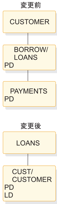
図 147. 論理子、物理対 - 物理削除規則または論理削除規則の例: 削除前および削除後
