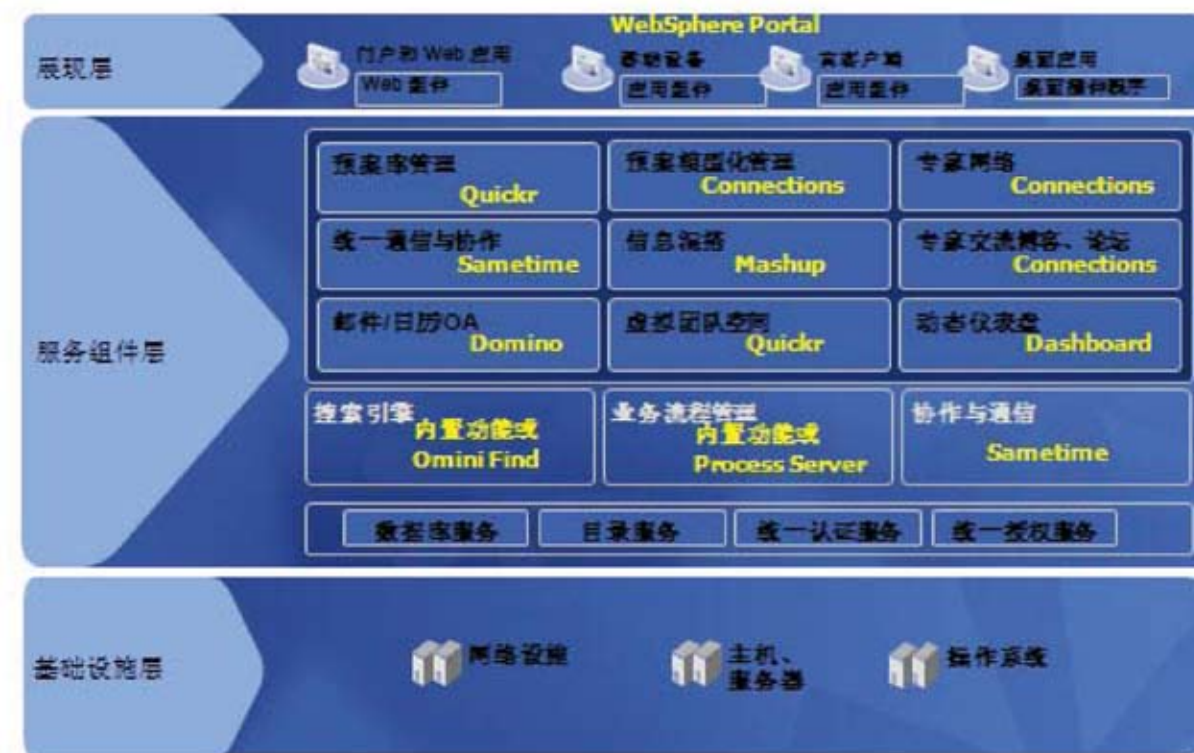
图表 1 基于Web2.0的易捷版应急联动指挥系统技术架构
