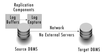
그림 8. DBMS 와 밀접하게 결합된 데이터 복제 방식. 외부 서버가 없으며, 로그 감지할 때의 적은 부하
