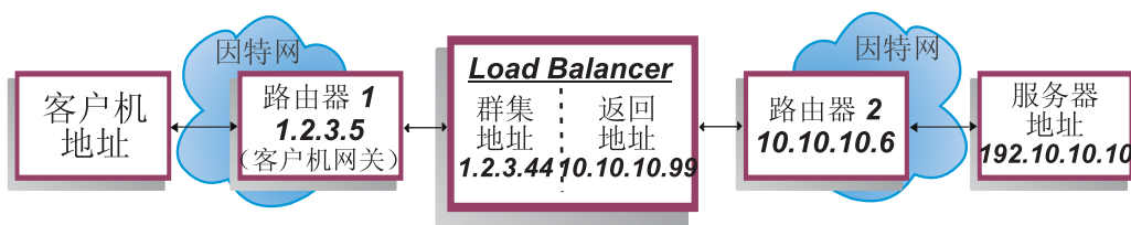
图 12. 使用 Dispatcher 的 nat 或 cbr 转发方法的示例
