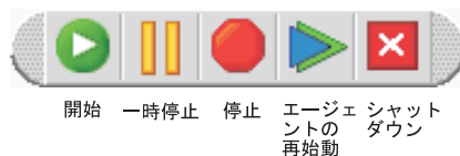
図 27. System Monitor、コンポーネントを開始、一時停止、再始動、またはシャットダウンするアイコン
