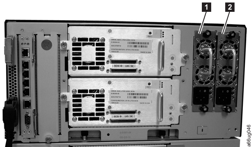
Рисунок 11-1. Источники питания в модуле управления
