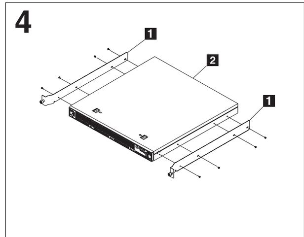
Conecte o suporte lateral **1** ao servidor **2** utilizando os parafusos de montagem do suporte.
