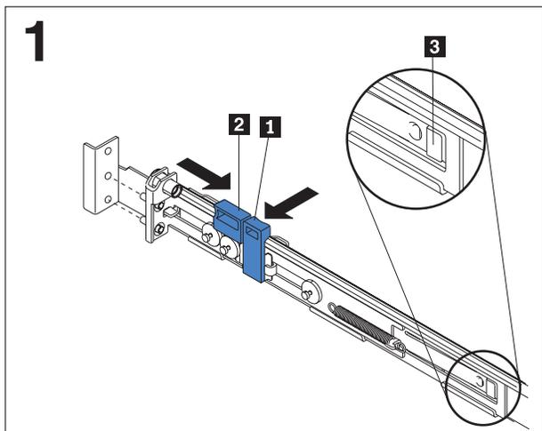
Pressione as presilhas **1** e **2** na parte frontal do rolamento de travamento do trilho e deslize-o em direção à parte posterior do trilho, até que ele se encaixe no lugar.
