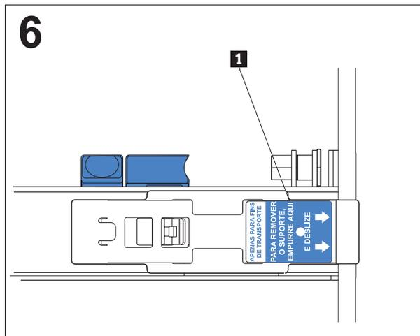
Pressione a presilha de liberação **1**, conforme indicado no suporte de transporte e deslize o suporte de transporte para fora do trilho deslizante. Repita esta etapa para o outro suporte de transporte. Guarde o suporte de transporte para uso futuro.
