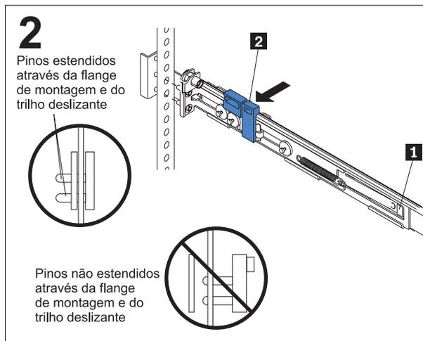
**Nota:** Caso precise ajustar o comprimento do trilho deslizante, levante a presilha de liberação **1** e estenda completamente o suporte para ajuste do trilho, a partir da parte posterior do trilho deslizante, até que ele se encaixe no lugar.
