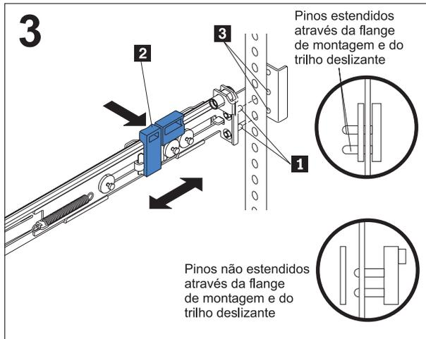
Alinhe os pinos **1** na parte frontal do rolamento de travamento de trilho com a flange de montagem da parte frontal. Se tiver ajustado o comprimento do trilho, empurre o rolamento de travamento do trilho de volta à parte posterior do trilho deslizante, para alinhá-lo com a flange de montagem **3**. Em seguida, pressione a presilha **2** para prender a parte frontal do trilho deslizante na flange de montagem frontal.
